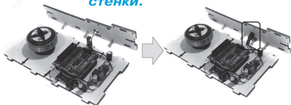
Рис. 26. Установка первой стенки.
